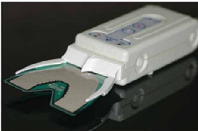
Fig. 4 La télécommande du TScan III se connecte directement à l'ordinateur avec une clé USB.<sup>4-5</sup>
